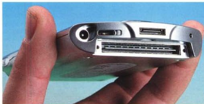
Il connettore più piccolo è dedicato al collegamento del supporto da tavolo, mentre quello più esteso è l'interfaccia con le Jacket Card, i supporti di espansione dedicati. Ai lati dello chassis troviamo il connettore dell'alimentazione, il tasto di reset e lo sportellino che nasconde al suo interno l'attivazione/disattivazione della batteria.
